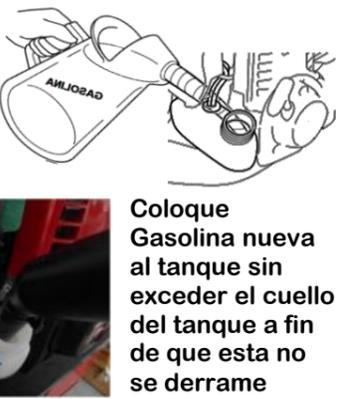
Coloque Gasolina nueva al tanque sin exceder el cuello del tanque a fin de que esta no se derrame
