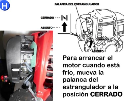
Para arrancar el motor cuando está frío, mueva la palanca del estrangulador a la posición **CERRADO**
