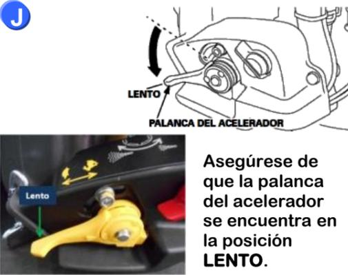
Asegúrese de que la palanca del acelerador se encuentra en la posición **LENTO**.
