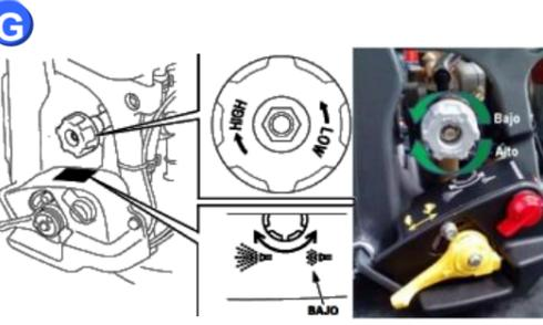
Gire el calibrador de presión hacia la izquierda (BAJO) hasta que se detenga y ciérrelo totalmente
