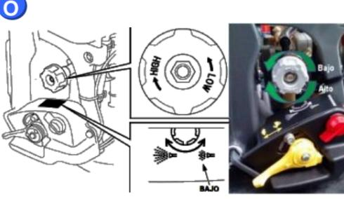
Gire el calibrador de presión hacia la izquierda (BAJO) hasta que se detenga y ciérrelo totalmente
