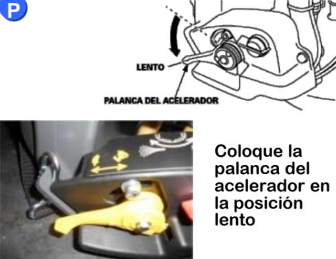
Coloque la palanca del acelerador en la posición lento
