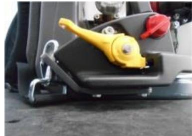
Coloque la palanca del acelerador en la posición deseada
